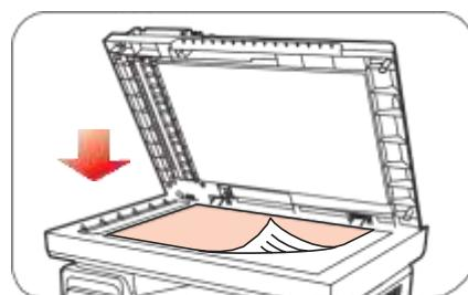
⑤ Натиснете Сканиране на контролния панел и натиснете бутона за посока „▲“ или „▼“, за да изберете „Сканиране на една страница“ или „Обединяване на сканиране“, за да влезете в режим на сканиране.
