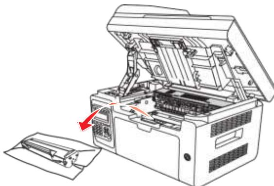
4. Отворете опаковката на новата лазерна тонер касета, хванете дръжката на касетата и леко разплатете около 5 до 6 пъти, така че тонерът да се разпредели равномерно вътре в касетата.
